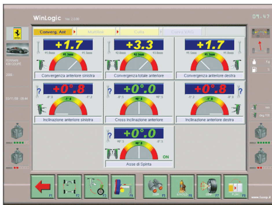
Regolazione convergenza anteriore Front wheel toe adjustment
