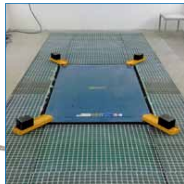
Bodenebener Einbau in der Spritzkabine.
