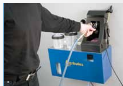
Die Farbkanal wird gespült.
