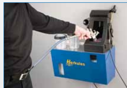
Die Luftkappe wird gesäubert.
