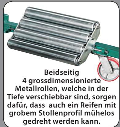
Beidseitig 4 grossdimensionierte Metallrollen, welche in der Tiefe verschiebbar sind, sorgen dafür, dass auch ein Reifen mit grobem Stollenprofil mühelos gedreht werden kann.
