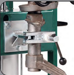
McPherson Federbein im Schraubstock montiert.
