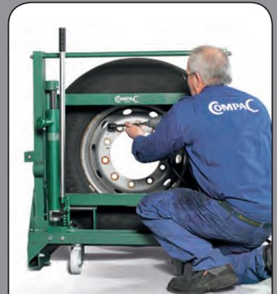
Der einfache Zugang zu den Radbolzen wird durch einfaches Öffnen der außermittig positionierten Hydraulikeinheit erreicht.
