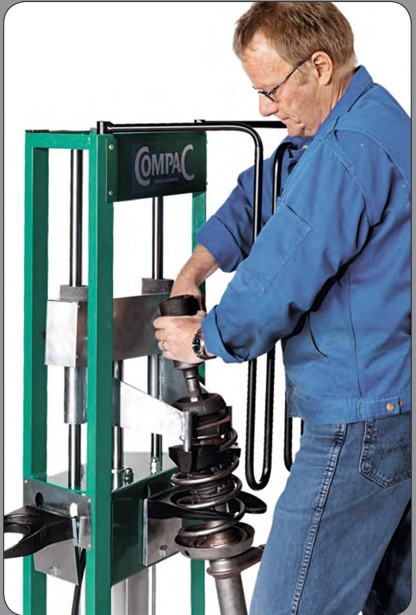
Eine einfache Zugang mit dem Schlagschrauber für die Montage und Demontage des Feders.
