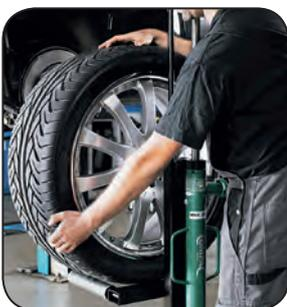
Kugelgelagerte Rollen vereinfachen Drehbewegungen und das Positionieren.
