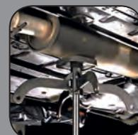
Ideal zum Aus- und Einbau von Abgasanlagen, Kraftstofftanks, usw.
