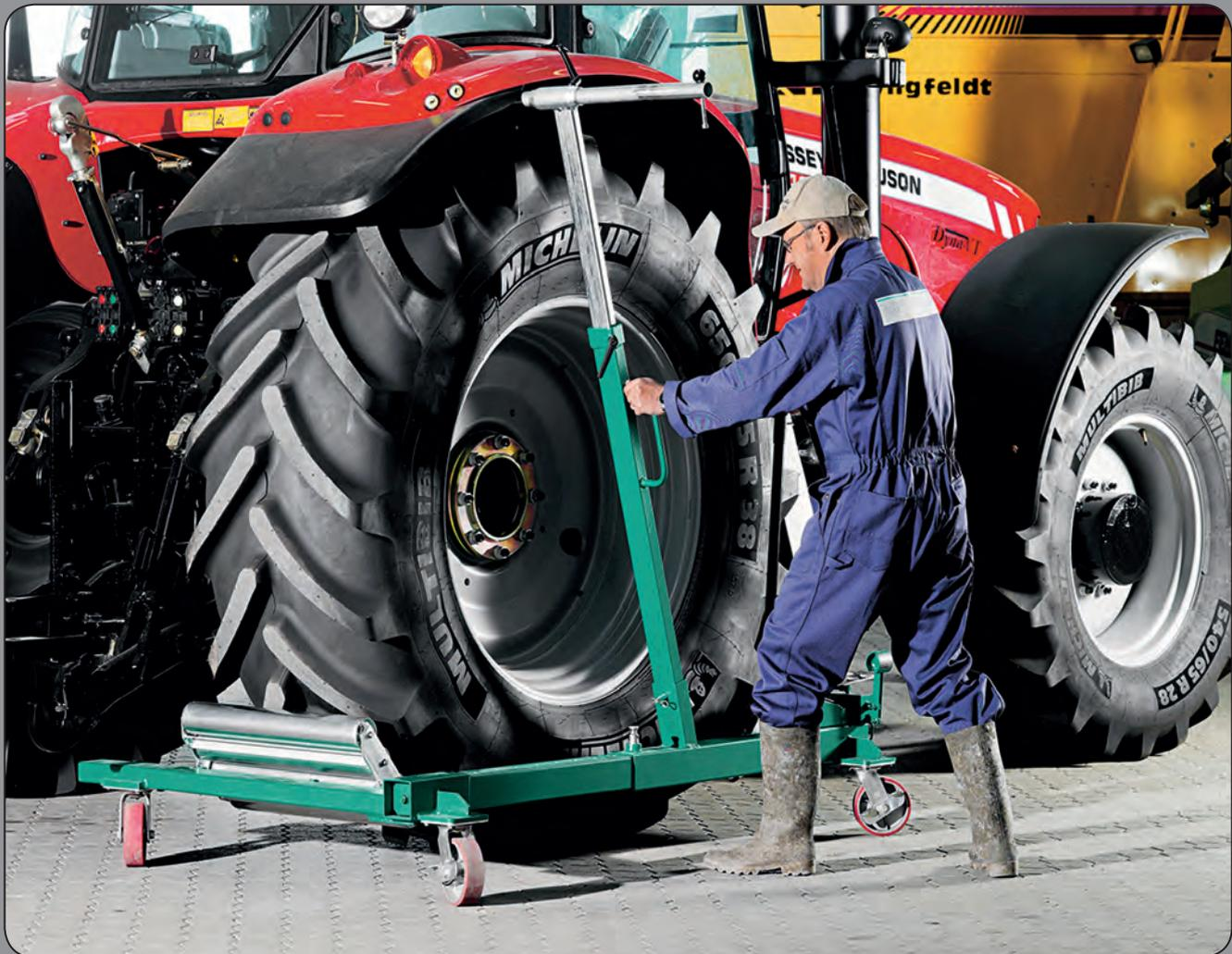
Einfache Handtierung großer Räder mit einem Durchmesser von 1150 mm bis zu 2150 mm und breiten Rädern bis zu 1050 mm.
